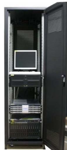
圖 4-2 16 nodes IBM Blade Center Cluster
