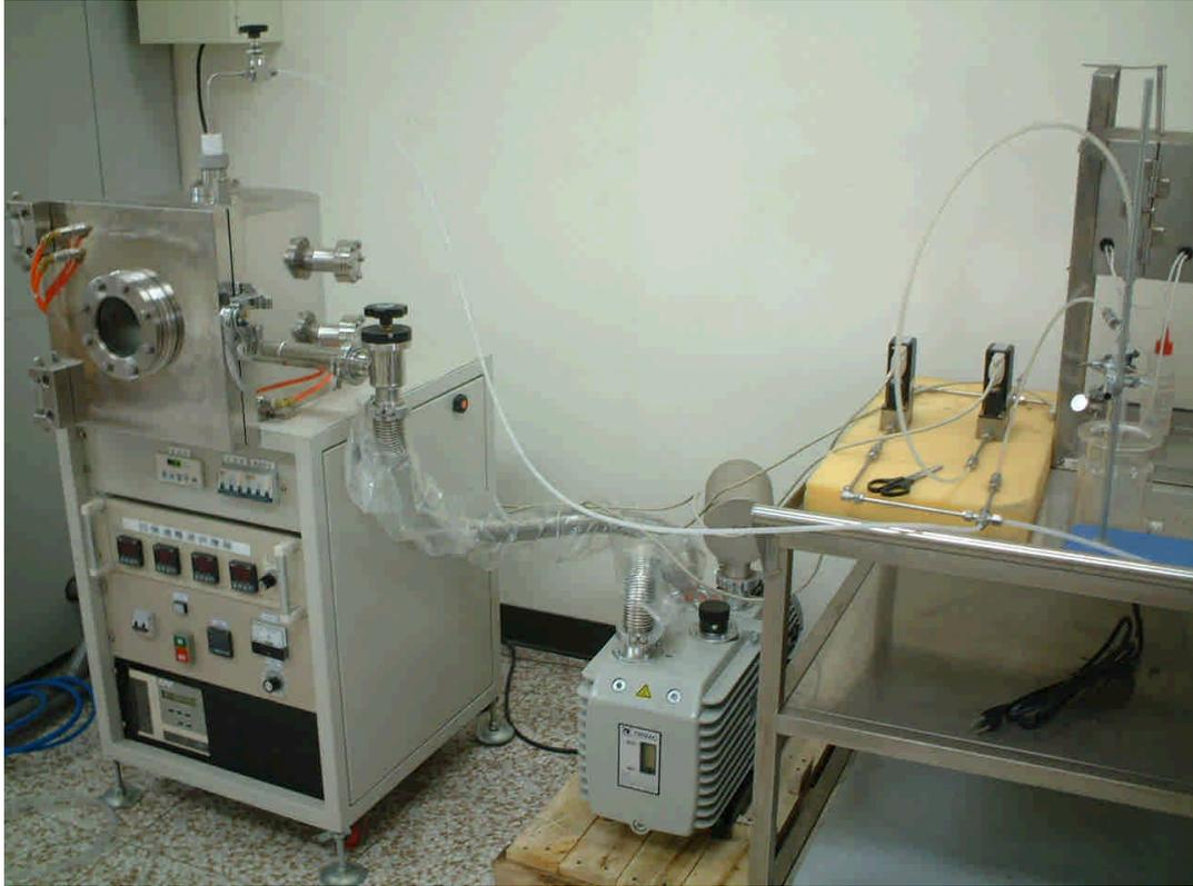
圖五 PECVD系統整體外觀
