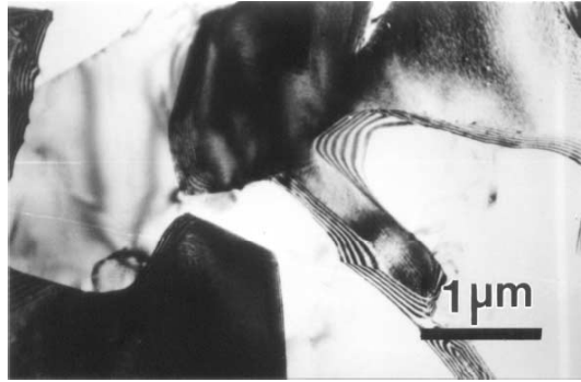
圖 1. 噴製狀態(as-spun)的 Al-5vol.%Al 3 (Ti 0.25 Zr 0.75 )合金薄帶之明視野影像
